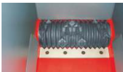
Rotor en V avec une rangée de couteaux
